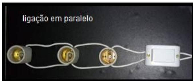
Figura 3.7 - Imagem fotográfica da ligação em paralelo
