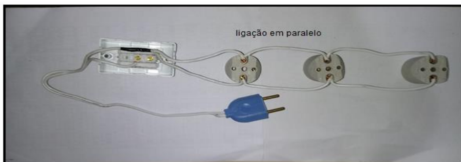
Figura 3.6- Imagem fotográfica da ligação em circuito em paralelo.
