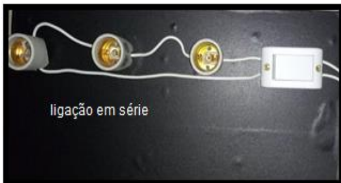
Figura 3.8- Imagem fotográfica da ligação em série
