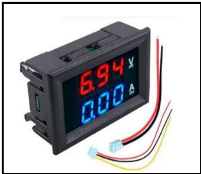
Figura 4.4- Imagem fotográfica do pequeno visor, com o intuito de demonstrar a tensão estabelecida no circuito.
